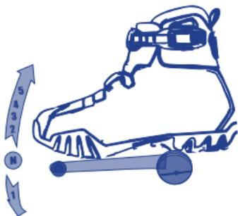
La AK180XM viene equipada con una caja de cambios de 5 velocidades que opera según la gráfica. Ésta se encuentra ubicada al lado izquierdo del motor.
