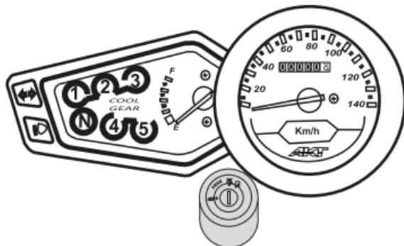
**⚠ ADVERTENCIA:** No deje el swicht en posición ON con el motor apagado, ya que puede disminuir la vida útil de su batería.
