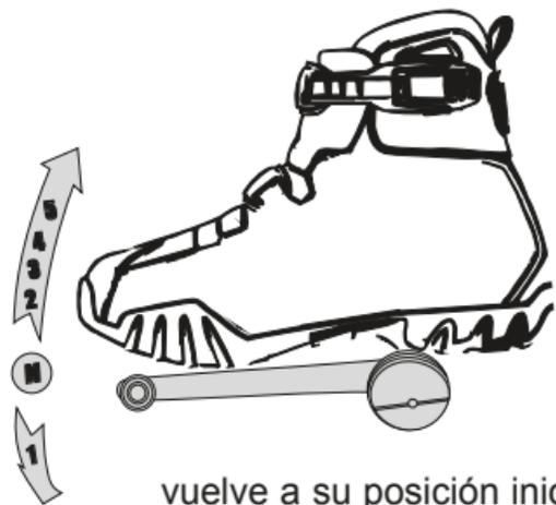
vuelve a su posición inicial y queda lista para seleccionar otro cambio. Empuje hacia arriba para aumentar los cambios y hacia abajo para disminuir. La neutra se encuentra entre primera y segunda, para situar la motocicleta en este cambio se debe tener una velocidad igual a cero.
