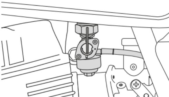
El grifo de paso de gasolina está ubicado en la parte lateral izquierda del tanque de gasolina.
