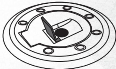
**2.** Introducir la llave en la ranura del switch presione y gire en el sentido de las manecillas del reloj.
