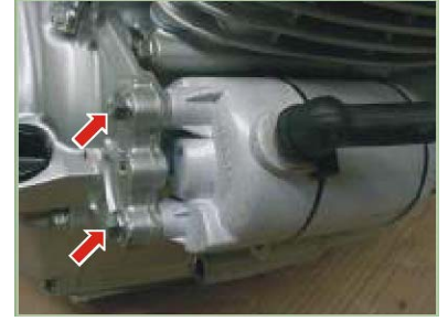
Tornillos marcha 1.1 Kg.-m
