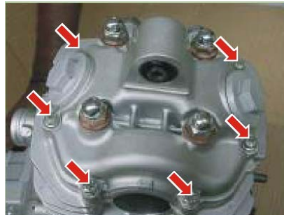
Tornillo tapa cabeza 1.1 Kg.-m
