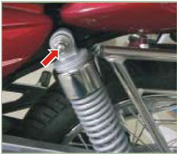
Tuerca amortiguador Trasero Arriba 3.5-4.0Kg.-m Abajo 2.7-3.0kg.-m
