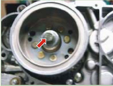
Tornillo rotor 4.5 Kg.-m
