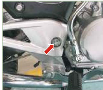
Tuerca eje basculante 8.0-10.0 Kg.-m
