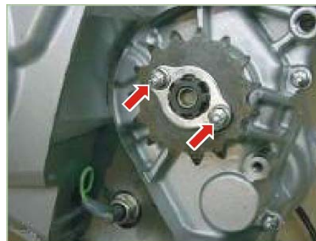
Tornillos seguro sprocket salida 1.1 Kg.-m
