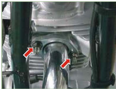
Tuercas silenciador 2-2.2 Kg.-m
