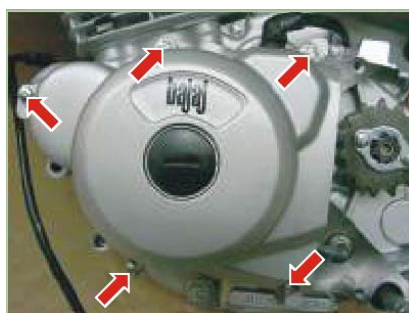
Tornillos tapa magneto 1.1 Kg.-m
