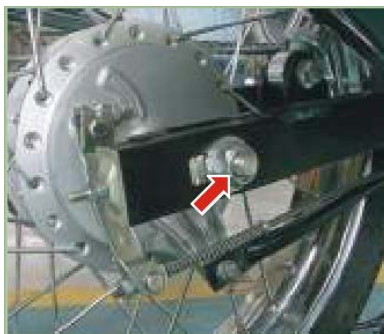
Tuerca eje trasero 8-10 Kg.-m
