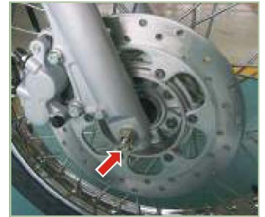
Tuerca eje delantero 4-5 Kg.-m
