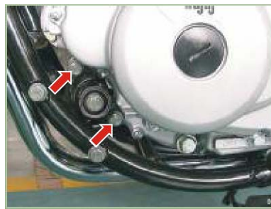
Soportes de motor M8 2.2 Kg.-m M10 2.4 kg.-m
