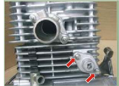
Tornillo tensor cadena 1.1 Kg.-m
