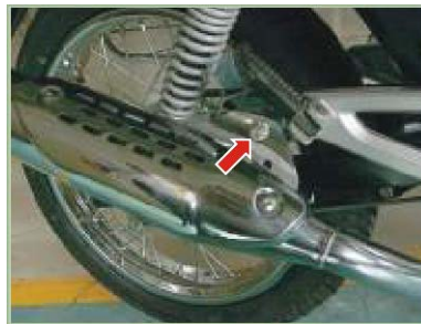
Tornillo silenciador 3.5-4.0 Kg.-m
