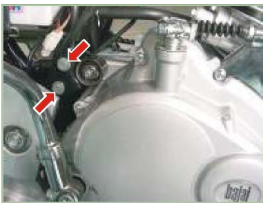
Soportes de motor M8 2.2 Kg.-m M10 2.4 kg.-m
