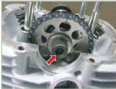
Tornillo arbol de levas 1.5 Kg.-m
