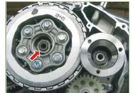
Tuerca clutch (rosca izquierda) 4.5 Kg.-m
