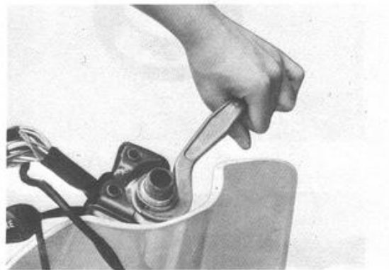
● ถอดนิตยึดแกนโช้คอัพ โดยใช้เครื่องมือพิเศษ และถอดตะเกียบหน้าออก
